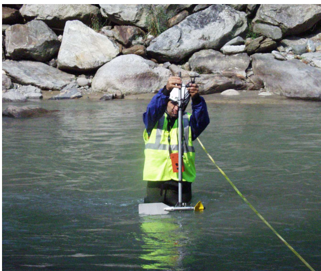
Figure 1/2. Misura di portata con mulinello idrometrico a guado (a sinistra) e con teleferica (a destra).
