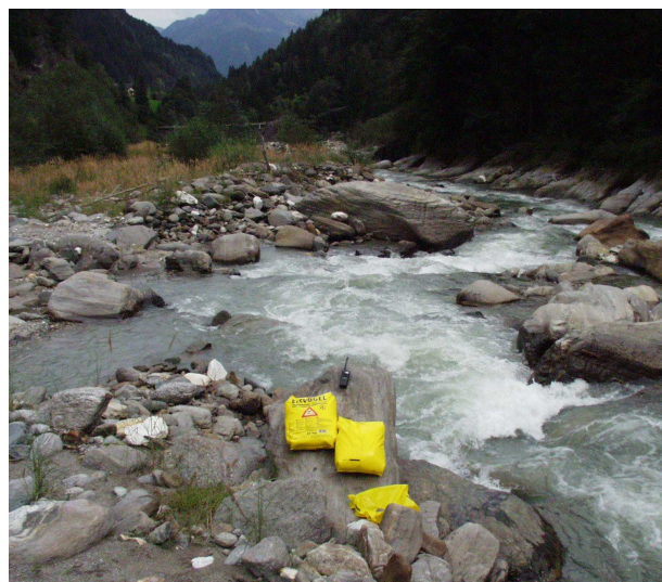
Abbildungen 1/2 Tracer-Abflussmessung: Eichtung der Messsonden (links) und Vorbereitung des Salzes zur Momentan- einspeisung (rechts).
