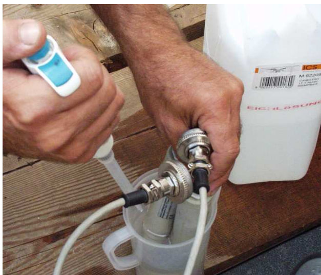
Figure 1/2. Misura di portata per diluizione salina: calibrazione sonda di misura (a sinistra) e posizione di immissione istantanea del sale (a destra).
