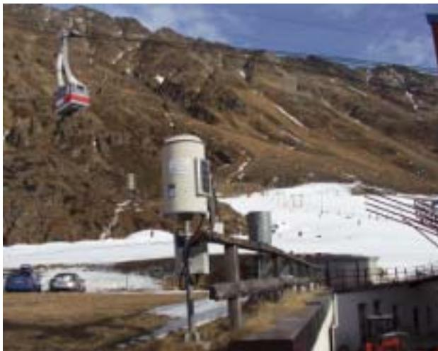
**Rechtes Bild:** Niederschlagsmesser und Temperatursensor der Messstation Kurzras im Schnalstal.
