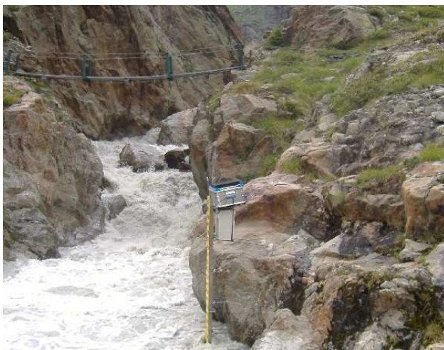
Figure 8./9. A sinistra stazione idrometrica sul rio Piana presso il rifugio Vedretta Piana. A destra confluenza di rio Piana e rio del lago Torbo subito a valle di tale stazione idrometrica. Il rio del lago Torbo drena un bacino grande circa la metà del primo ma è anzitutto l'assenza di aree glaciali a determinare la evidente diversa conduzione idrica.
