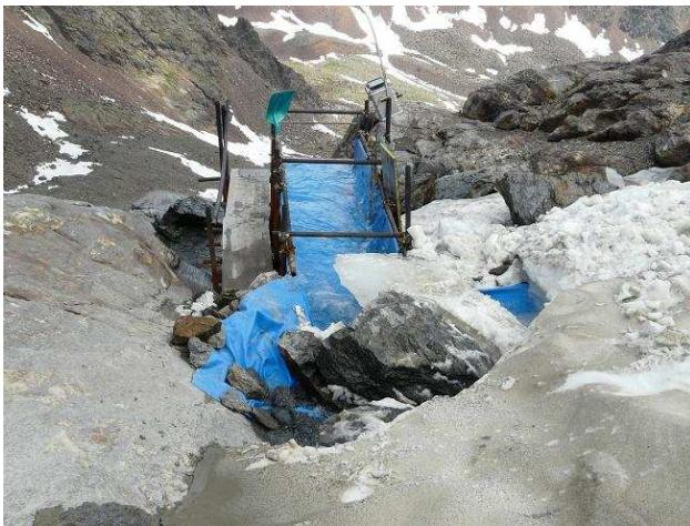
**Figura 7/8.** Stazioni idrometriche poste sui rivi glaciali e misura di portata presso la sezione in orografica destra (16.07.2009).
