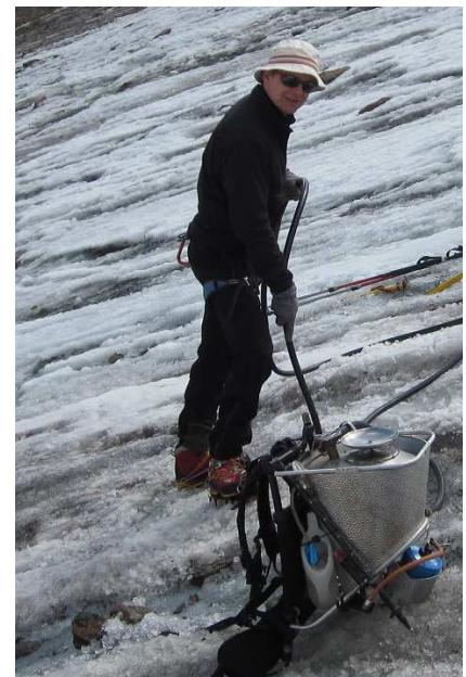
**Abbildungen 7/8/9.** Benützter Handbohrer auf den Gletschern im Ridnauntal (links) und Dampfbohrer des Typs Howorka/Trawöger (mitte) und Heucke Ice Drill (rechts), der aktuell zur Ausstattung des Hydrographischen Amtes gehört.
